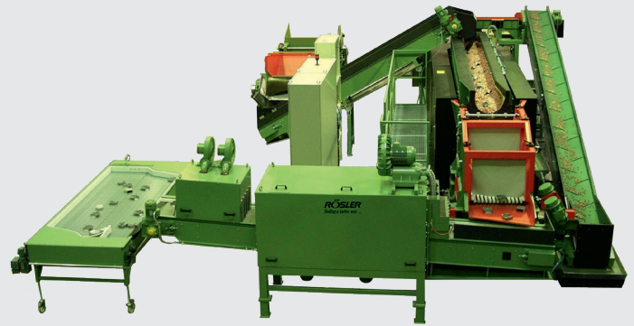
Linear-Durchlaufanlage mit Werkstückbeschickung, über Vario-Puffer mit Wiegetechnik und Zuführband, Bandtrockner, Kühlstation, Werkstückspeicher
