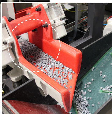
Untere Querförderrinne mit Schleppwassersiebsegment und Schleifkörpertransportband
